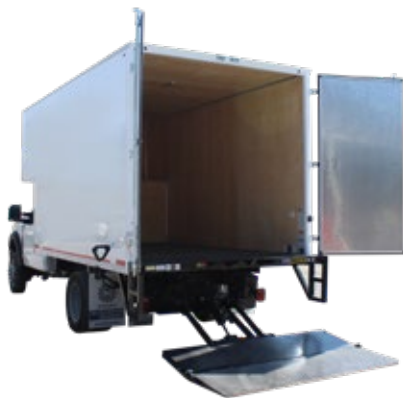
CAJA SECA CON RAMPA HIDRÁULICA
